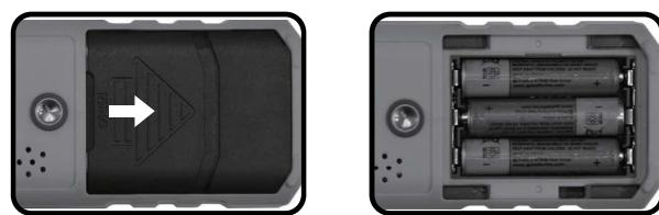
Откройте крышку батарейного отсека на задней части прибора. Соблюдая полярность, вставьте батареи, затем закройте крышку.
